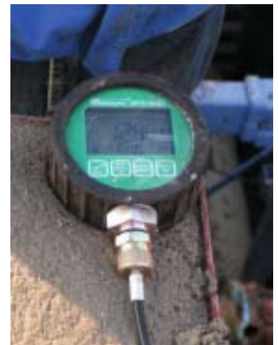
Auftriebsmessung mit Datentrigger.
