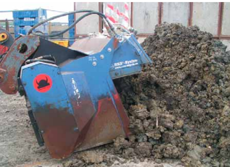
SkanCraft- Schaufelseperator und RSS-Dosiereinheit, eine untrennbare Einheit für hohe Leistungen bei der Verarbeitung schwieriger Böden.
